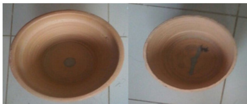
Figura 2.2 Preenchimento do fundo dos vasos com cola epóxi (Própria, 2016).
