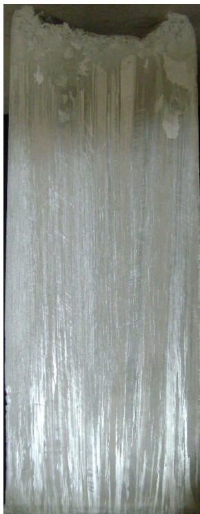
Figura 2 – Macroestrutura da liga Al-6%Zn (aumento de 1x).
