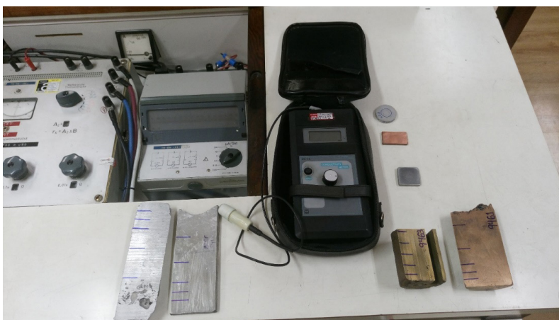
Figura 4 – Equipamento de laboratório da Termomecanica e corpos de prova. A amostra de Al-6%Zn foi ensaiada pelo equipamento eletrônico cujos dados de saída são os valores da condutividade em I.A.C.S. Fonte: autor, 2019.
