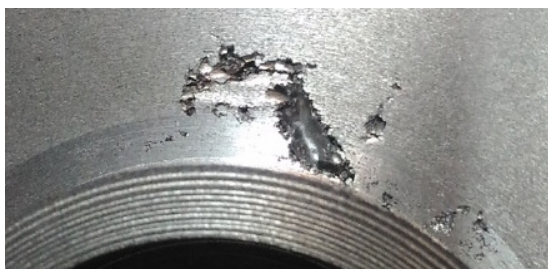
Figura 1: Característica da falha (Porosidade).
