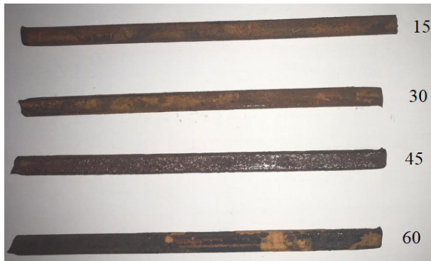
Figura 2: Corrosão em meio ácido.
