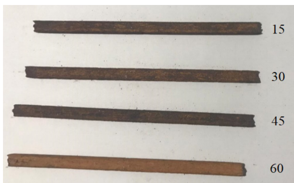
Figura 1: Corrosão em meio ácido.
