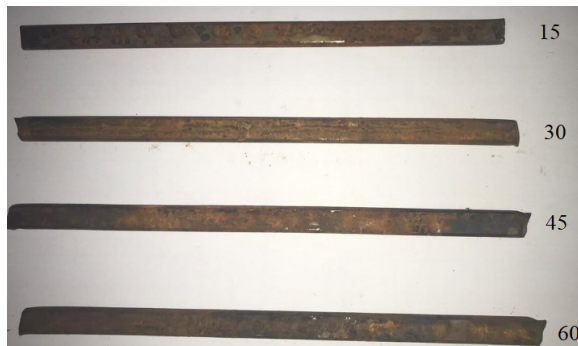
Figura 3: Corrosão em água destilada
