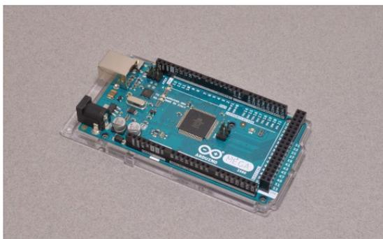
Figura 1: Arduino Mega 2560.
