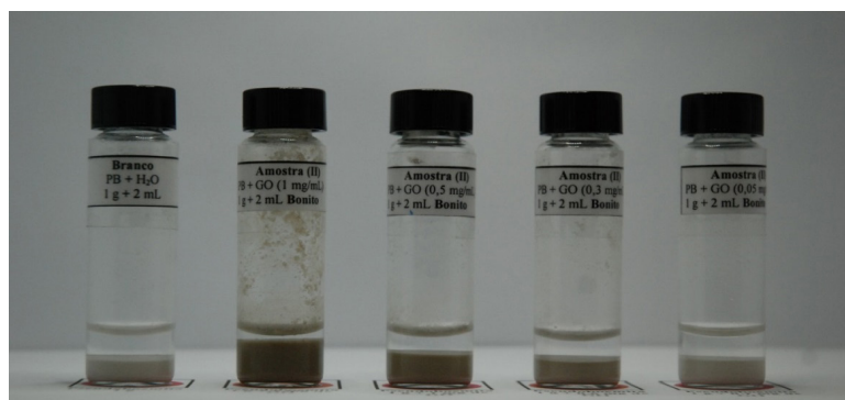
Figura 2 – Compósitos formados por PB dopados com GO (II)
