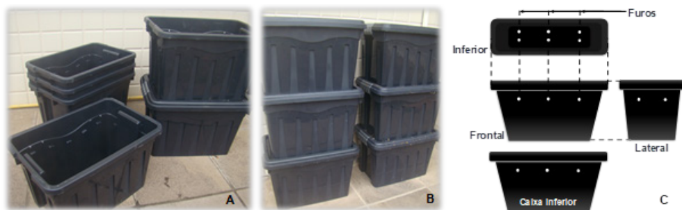
Figura 1: Conjunto de caixas utilizadas para a montagem das composteiras (A e B) e esquema do conjunto montado (C)
