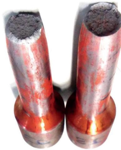
Figura 8. Amostra jateada - fratura dúctil.
