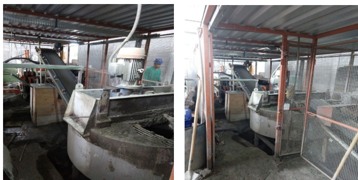
Figura 1- Vista do misturador e esteira de transporte.
