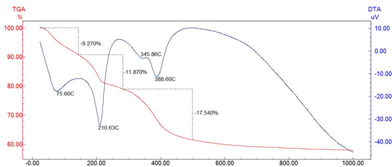
Figura 3 - Curva DTA-TGA da amostra HDL
