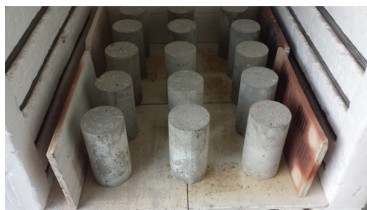
Figura 5: Placas de cerâmicas instaladas nas lateral
