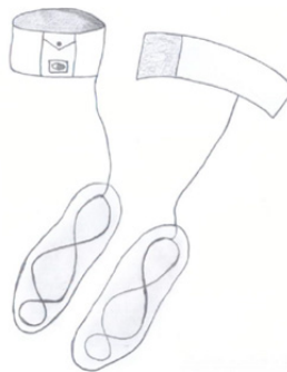
Figura 2 - Ilustração da palmilha com sistema de aquecimento
