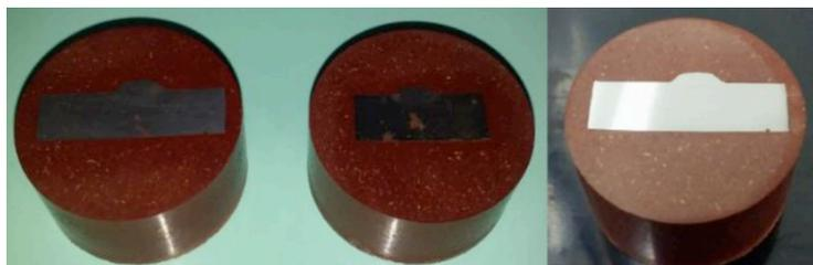
Figura 1 - Amostras AM 01, AM 02 e AM 03 embutidas.
