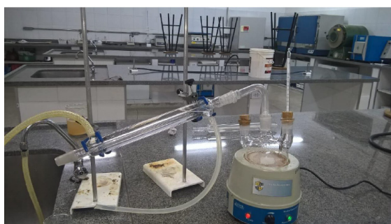
Figura 5: processo de destilação simples.
