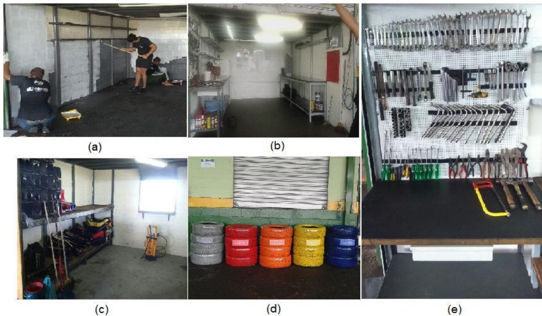
Figura 5: a) Pintura do Box oficina; b) Padronização do Box oficina; c) Padronização do depósito de materiais; d) Criação de descarte adequado para o lixo; e) Padronização do quadro de ferramentas. Fonte: Elaborado pelos autores.
