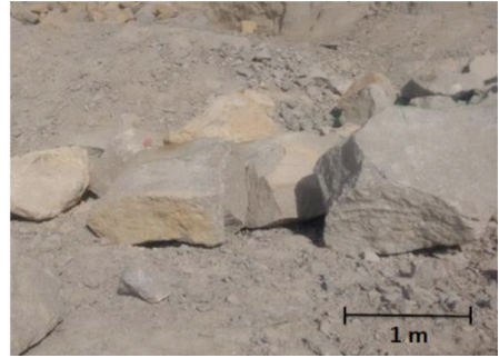
Figura 1 - Blocos de rocha com dimensões incompatíveis com maquinário
