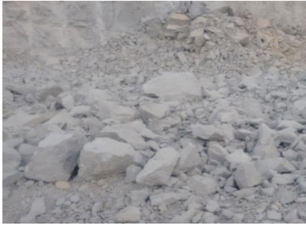
Figura 1 - Blocos de rocha com dimensões incompatíveis com maquinário
