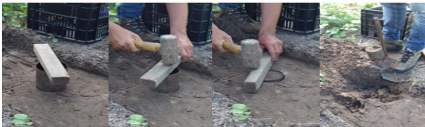
Figura 2: Método de coleta por cilindros.
