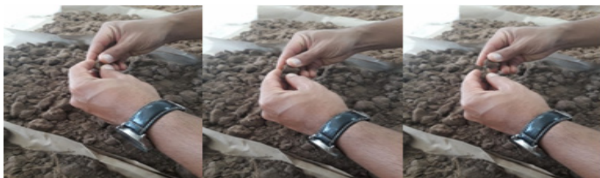
Figura 4: Desagregação do solo através de seu ponto de fragilidade natural.
