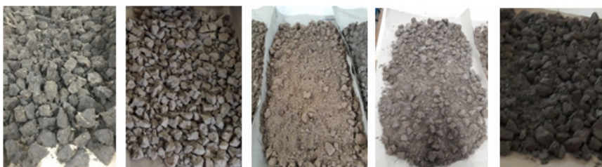
Figura 5: Amostras de diferentes classes de solo separadas pelos seus pontos de fragilidade natural.
