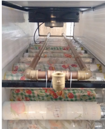
Foto 4: Distribuidor com PVC em que a água irá passar e molhar as latas através de gotejamento.
