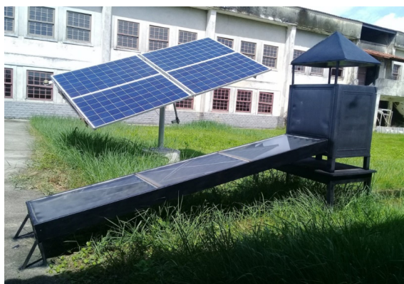
Figura 1. Secador híbrido solar elétrico utilizado para a secagem do café.
