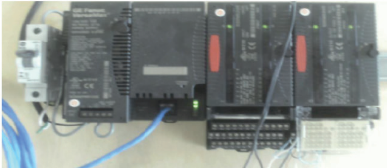
Figura 2 – Exemplo do CLP GE FANUC VERSAMAX
