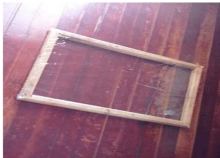
Figura 4 – Montagem da tampa
