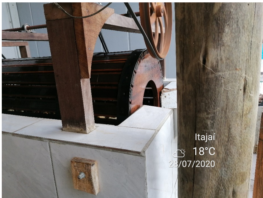
FIGURA 02: Máquina utilizada para lavar e remover a película externa da raiz do aipim, adquirida pela Cooperar, cooperativa de agricultores de Itajaí.
