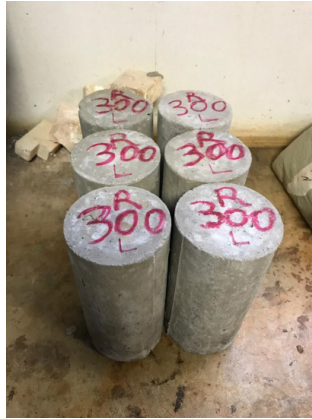
Figura 4 - Corpos de prova elevados a 300°C sendo resfriados lentamente
