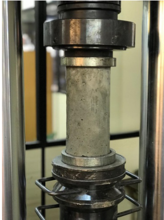
Figura 6- Ensaio de Resistência à compressão
