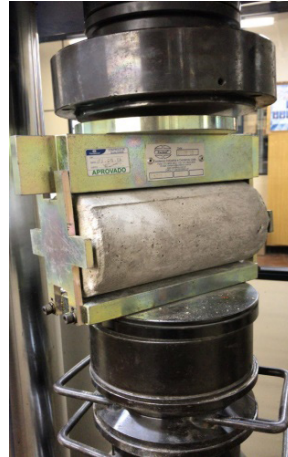
Figura 7- Ensaio de Resistência à tração por compressão diametral
