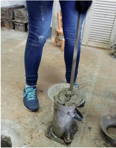
Figura 1 - Adensamento dos corpos de prova através de haste metálica
