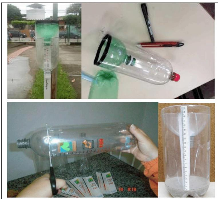
Figura 03: Fabricação de um pluviômetro
