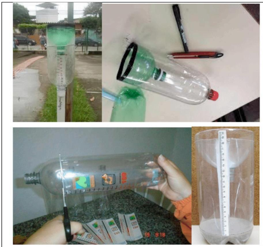
Figura 02: Fabricação de um pluviômetro
