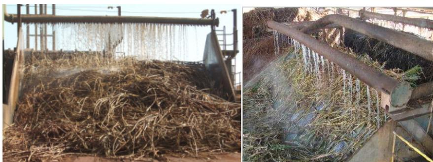
Figura 1: Ilustração da limpeza da cana-de-açúcar com água na recepção
