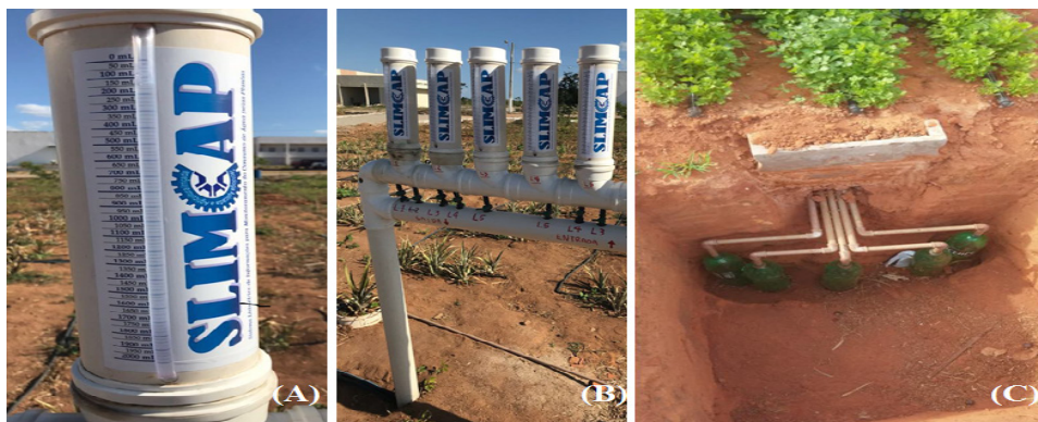
Figura 3. Sistema SLIMCAP em campo, reservatório de fornecimento de água (A), recipiente de entrada de água para os lisímetros (B) e sistema coletor, drenos (C).
