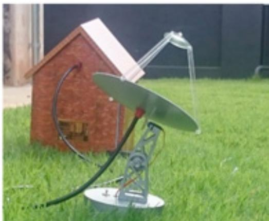
Figura 6 – Teste do protótipo funcional do coletor solar
