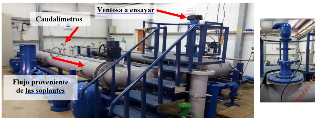
Figura 4. Banco de ensayos de ventosas en expulsión y admisión en Bernad.
