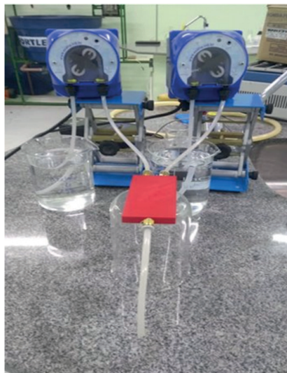
Figura 4 – Sistema reacional composto por duas bombas peristálticas e o microrreator.
