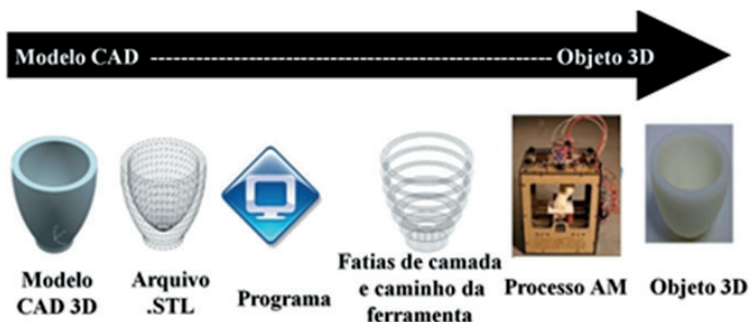
Figura 2 - Processo de Fabricação Aditiva Generalizado
