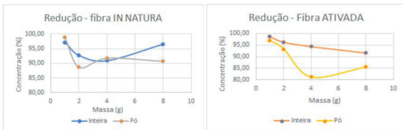
Figura 6: Redução da Prata na Fibra in natura e ativada
