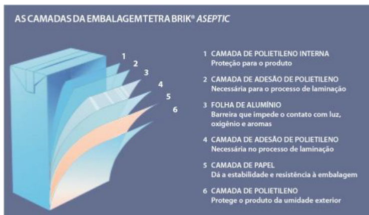
Figura 1 – Estrutura das embalagens cartonadas assépticas.
