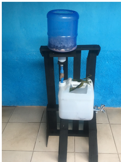
Figura 1– Sistema de Filtração desenvolvido para melhoria da qualidade da água
