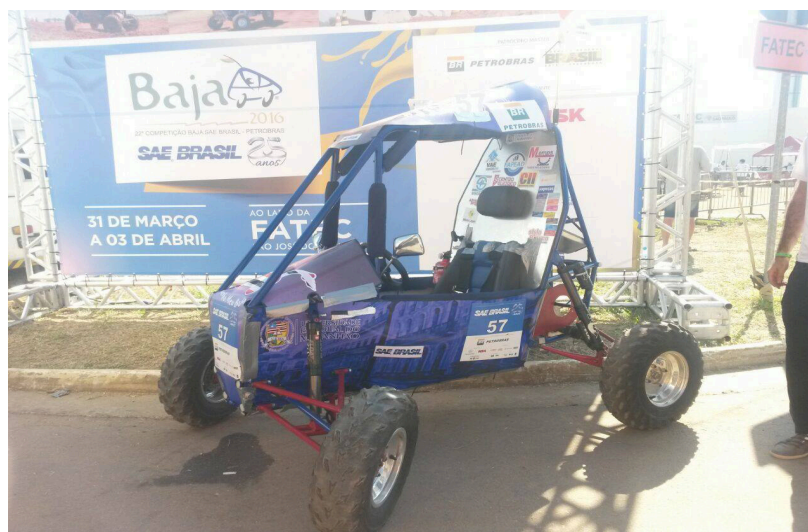
FIGURA 2 – Veículo de competição off road construído pela equipe Bumba Meu Baja.
