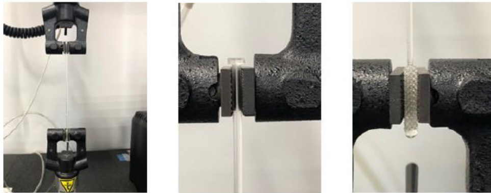
Figura 5: ensaio de resistência mecânica sob tração de swabs poliméricos.
