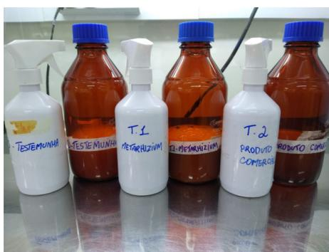
Figura 4. Recipientes estéreis (frascos escuros) e borrifadores (frascos brancos) contendo a solução testemunha e as suspensões de fungo entomopatogênico dos diferentes tratamentos.
