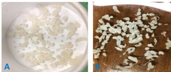
Figura 1. A - Microesferas de quitosana após filtração; B - Microesferas após secagem.
