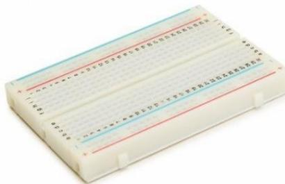
Figura 09 - Protoboard 400 pontos
