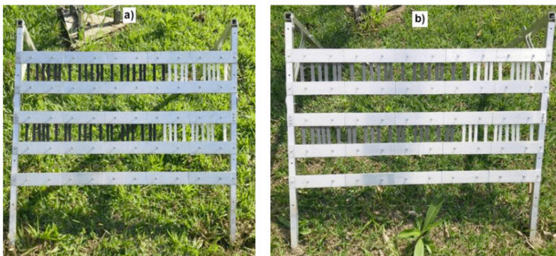
Figura 2 - Corpos de prova a) antes e b) depois do ensaio de degradação por envelhecimento natural.
