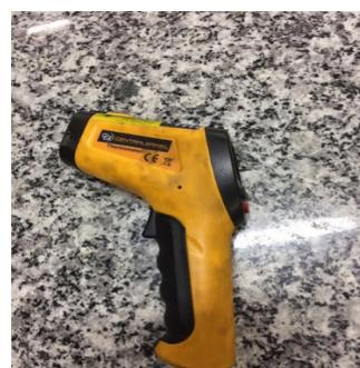
Figura 4 -Termômetro Infravermelho
