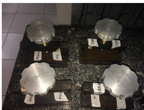
Figura 5 - Dispositivos utilizados para realização dos ensaios de deformação permanente à compressão (Compression set)
