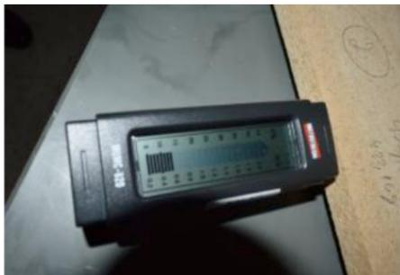
Figura 1. Medidor de umidade Instruthern Modelo MUMC- 620
