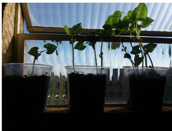
Figura 1: A amostra da esquerda foi regada com água, a amostra central foi fertilizada com NPK e a amostra da direita foi fertilizada com o líquido natural do biodigestor.
