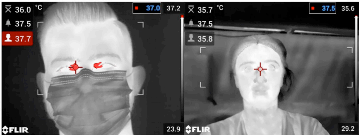
Figura C - À esquerda: captura termográfica de um paciente com febre. À direita: paciente sem febre. Ambas imagens com alarme sonoro configurado em 37,5° C. Os pacientes tiveram a temperatura medida e confirmada por termômetro digital.
