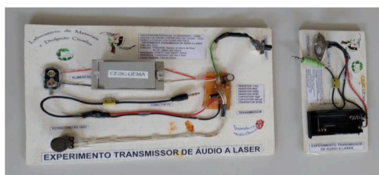
Fig. 5 – Transmissor de áudio a laser.
