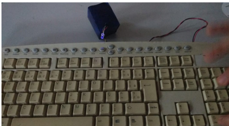
Fig. 3 – Gerador de Energia Elétrica com o Teclado.
