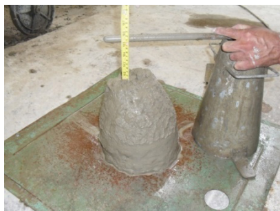
Figura 5 Abatimento do tronco de cone de Abrams.
