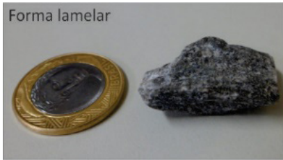
Figura 3 Forma lamelar e alongada-lamelar do agregado graúdo
