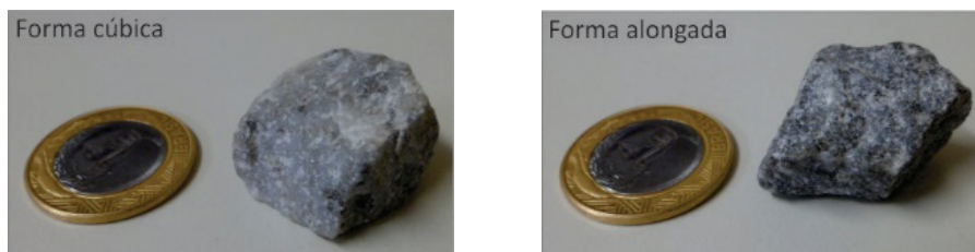
Figura 2 Forma cúbica e alongada do agregado graúdo
