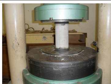
Figura 6 Ensaio à Compressão.
