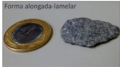
Figura 3 Forma lamelar e alongada-lamelar do agregado graúdo
