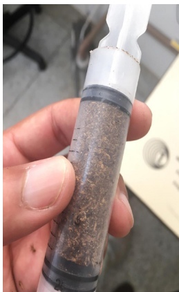
Figura 3: Compactação do composto, juntamente com os aditivos propostos, para formação dos pellets.
