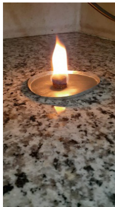
Figura 7: Pellet durante a submissão a uma fonte de calor.
