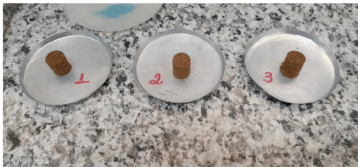
Figura 5: Pellets utilizados no cálculo do poder calorífico.
