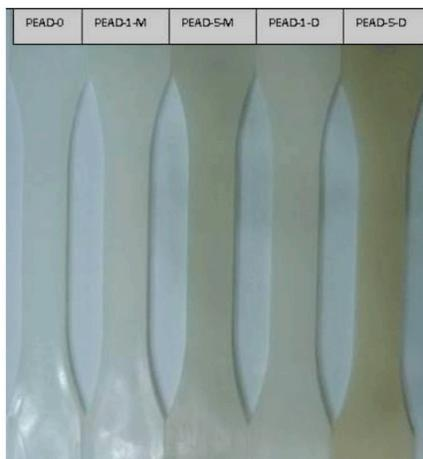
Figura 2. Aspecto dos corpos de prova após o processamento.
