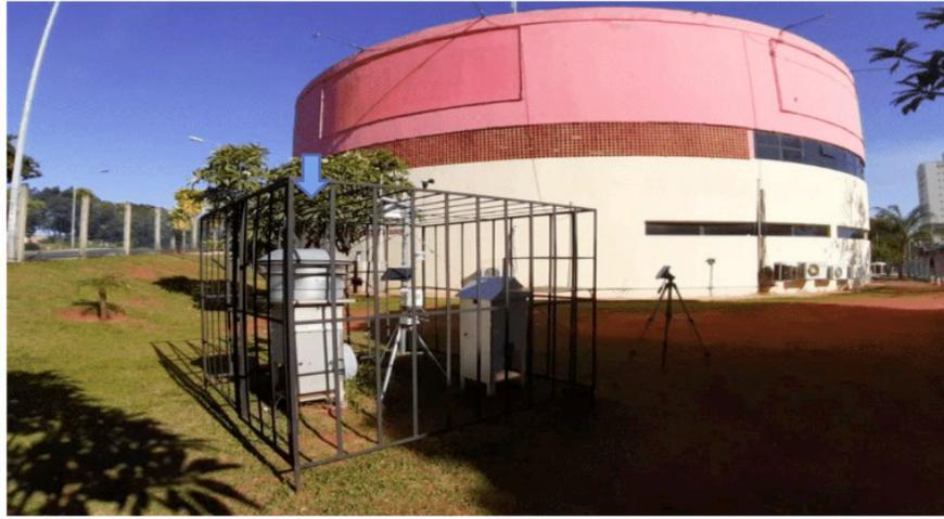
Figura 3 – AVG-MP<sub>10</sub>. No local instalado.
