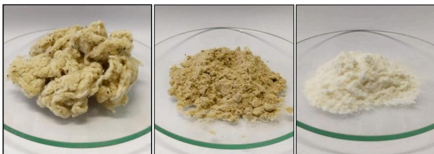
Figura 1 - Amostra de línter de algodão secas em estufa em diferentes etapas do processo. Da esquerda para a direita, lavado, pré-hidrolizado e branqueado.
